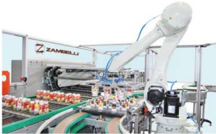
Applicazione robotizzata per gadget con sistema pick&place
